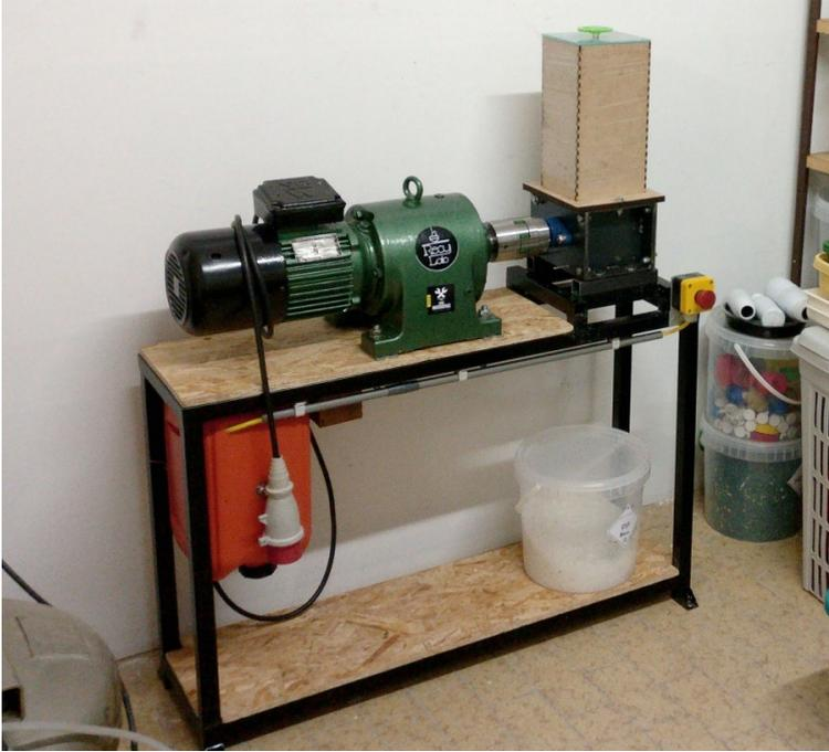
Le broyeur est la machine centrale du projet Precious Plastic.
